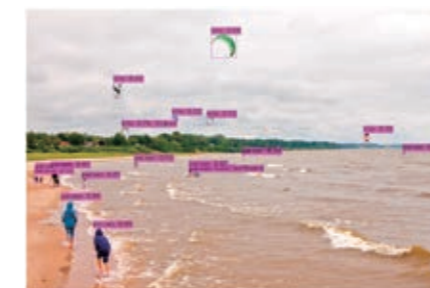
図1: DLアルゴリズムの一つ、YOLOv3による画像認識。多数の物体を高精度で認識している。遠方の非常に小さい物体も高い精度で認識可能である。
